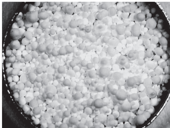
Rys. 2. Mikrogranulki PCM, w pojemniku do badań kalorymetrycznych (DSC), średnica pojemnika 6,8 mm
