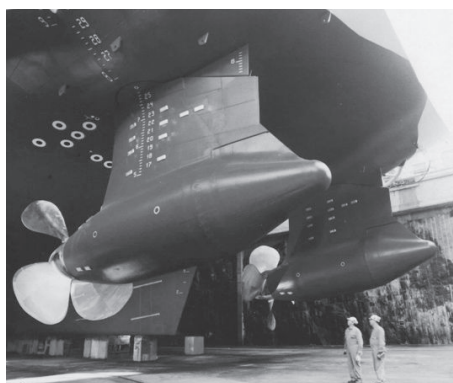
Rys.2. Nowoczesne pędniki azymutalne z zabudowanymi silnikami elektrycznymi o mocy 14MW [2]
