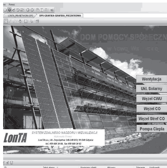
Rys. 4. Okno dialogowe systemu TAC Vista 2000 system TAC Vista 2000 do zarządzania i nadzoru nad instalacjami w budynkach DPS.
