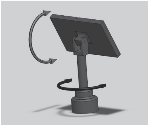
Fig. 2 Back structure of a DAT heliostat
