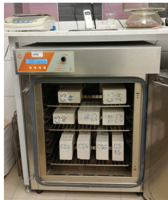
Rys. 3. Suszenie górnych połówek silikatów
