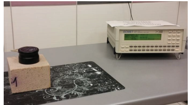
Rys. 2. Badanie parametrów cieplnych na połówkowych próbkach cegły silikatowej
